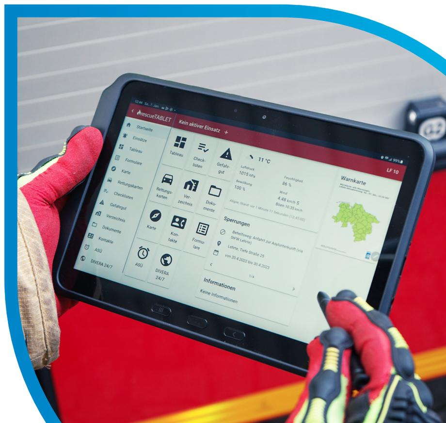
Die Feuerwehr Lehrte nutzt die Tablets mit aktiven Ladehalternungen in den Einsatzfahrzeugen. Die an den Geräten vorhandenen POGO-Pins ermöglichen eine direkte Ladung ohne separates Ladekabel. So können die Feuerwehrleute sicherstellen, dass die Akkus vor jedem Einsatz ausreichend geladen sind.
