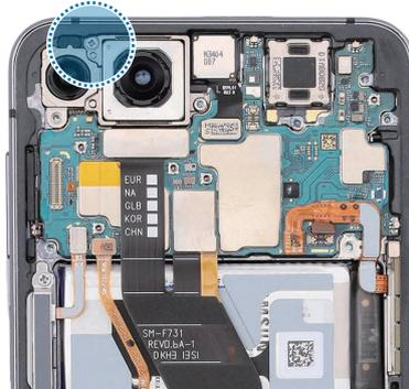
6 Use las pinzas para colocar la tapa posterior superior en la posición correcta y presiónela suavemente para fijarla en su sitio hasta que escuche un sonido de bloqueo.
