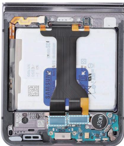
3 Compruebe los tornillos 3442 (2 unidades) en los dos puntos distintos del puerto de carga y fíjelos con el destornillador de estrella.
