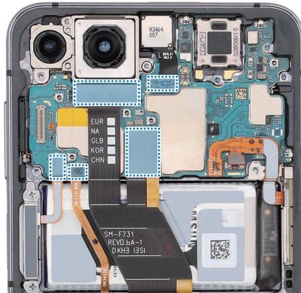
4 En el caso de los dispositivos 5G de Estados Unidos, use las pinzas o los dedos para conectar el conector adicional de la antena 5G mmWave de la placa principal.
