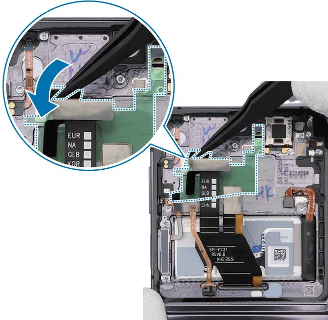
4 Sostenga con los dedos el agarre de la película de protección trasera inferior y retire la película de protección colocada en el módulo de pantalla nuevo.
