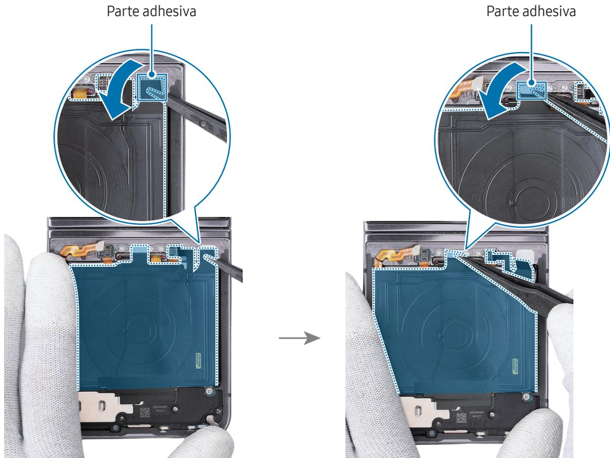
7 Use las pinzas para levantar la parte central inferior del módulo del altavoz con cuidado y extráigalo del dispositivo con cuidado.
