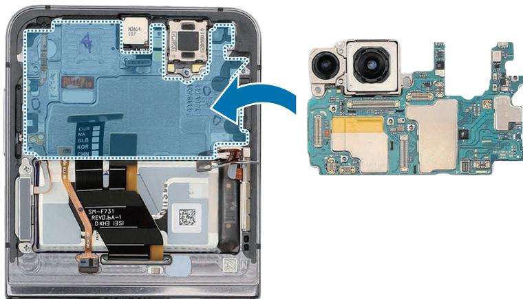
**2** Después de acoplar la parte inferior de la placa principal en diagonal sobre el módulo de pantalla, monte la parte superior.
