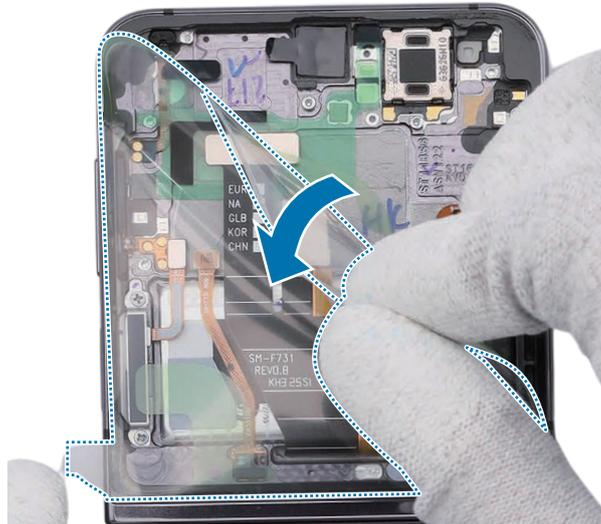
2 Con las pinzas, retire la película de protección de la cámara colocada sobre el nuevo módulo de pantalla.
