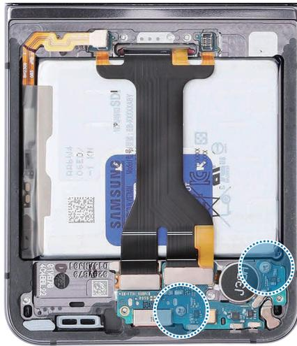
4 Compruebe cuidadosamente con los dedos si hay tornillos u otros elementos extraños dentro del dispositivo (batería, PBA, cable, etc.).
