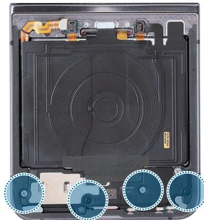
5 Use la púa de apertura para desconectar el conector de la antena NFC.
