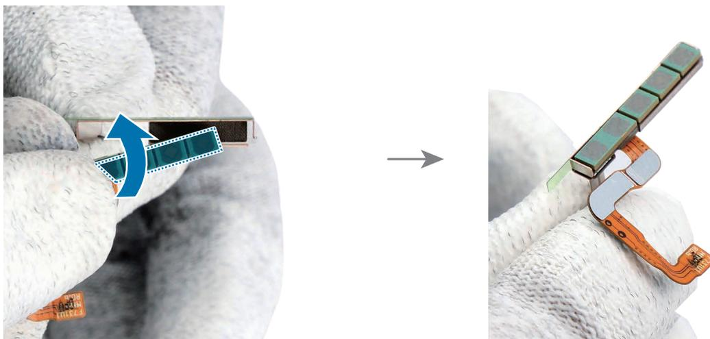
4 Retire el revestimiento adhesivo fino del exterior del soporte de metal.
