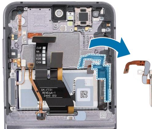
3 Separe la antena 5G mmWave y el conector del soporte de metal.
