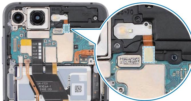
8 Compruebe los tornillos 3506 (2 unidades) en los dos puntos distintos y fíjelos a la tapa posterior superior.
