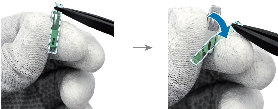
4 Combine el soporte de plástico con el módulo del botón Función instalado y móntelo en el módulo de pantalla.
