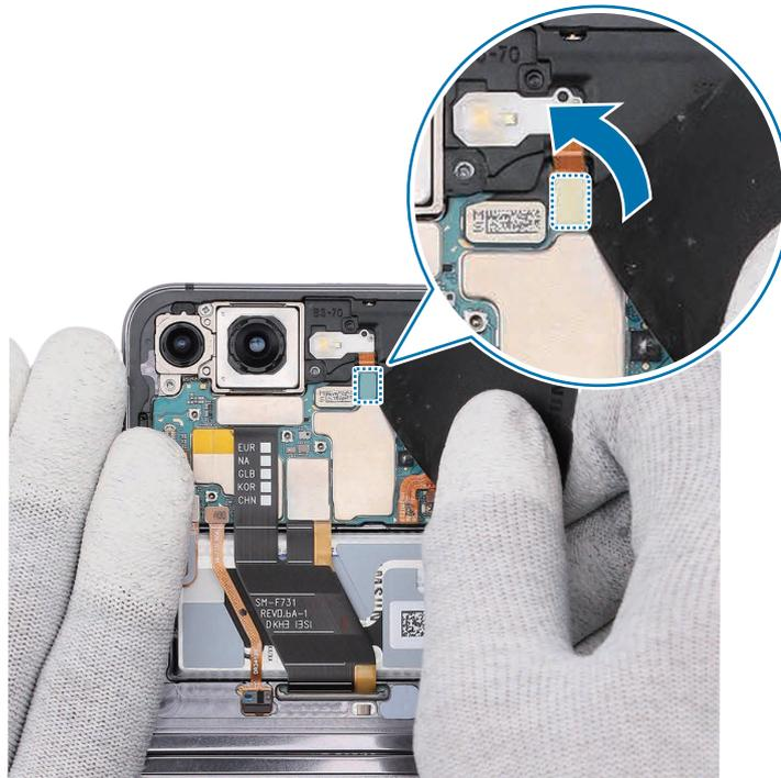
6 Con las pinzas, levante la muesca de separación hacia la esquina derecha de la tapa posterior superior y retírela.
