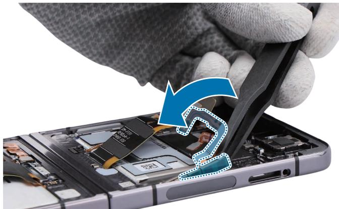
2 Retire el módulo de la antena 5G mmWave.
