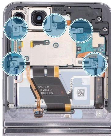
2 Use las pinzas para levantar la parte superior de la placa metálica inferior con cuidado y sepárela del dispositivo.
