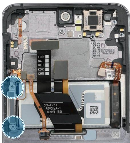
2 Con las pinzas, retire el soporte de metal del módulo de la pantalla.
