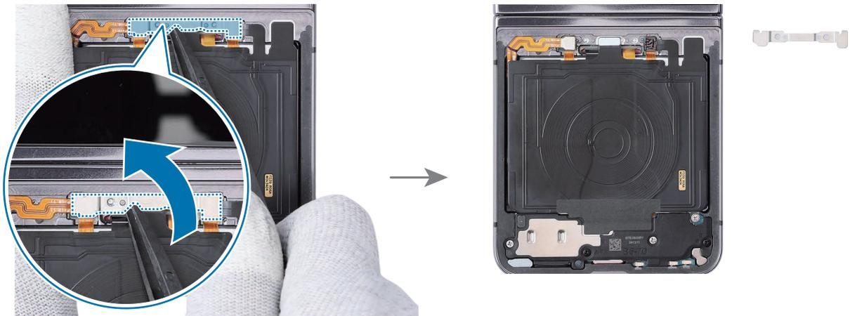
3 Desconecte el conector secundario de la batería con la púa de apertura.
