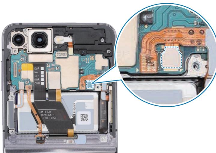
10 Use las pinzas o los dedos para montar la placa metálica superior con cuidado y presiónela hacia abajo en su sitio.
