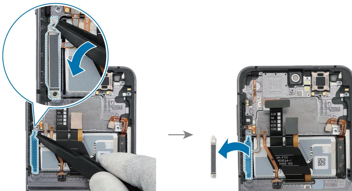
3 Con las pinzas, retire el soporte de plástico del módulo de pantalla. El módulo del botón Función se retira junto con el soporte.
