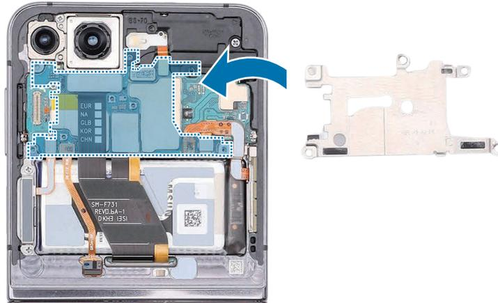
11 Compruebe los tornillos 3506 (5 unidades) en los cinco puntos distintos de la placa metálica superior y fíjelos con el destornillador de estrella.
