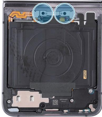
2 Use las pinzas para levantar la placa metálica inferior con cuidado y sepárela del dispositivo.
