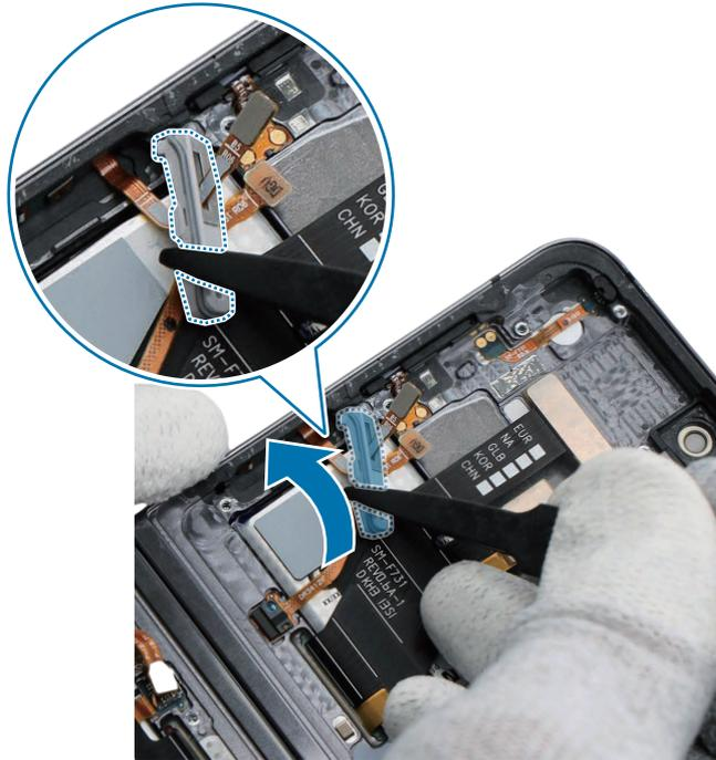
5 Use las pinzas para alinear la nueva cinta de la rejilla de ventilación de forma precisa en la parte inferior del soporte y fíjela.
