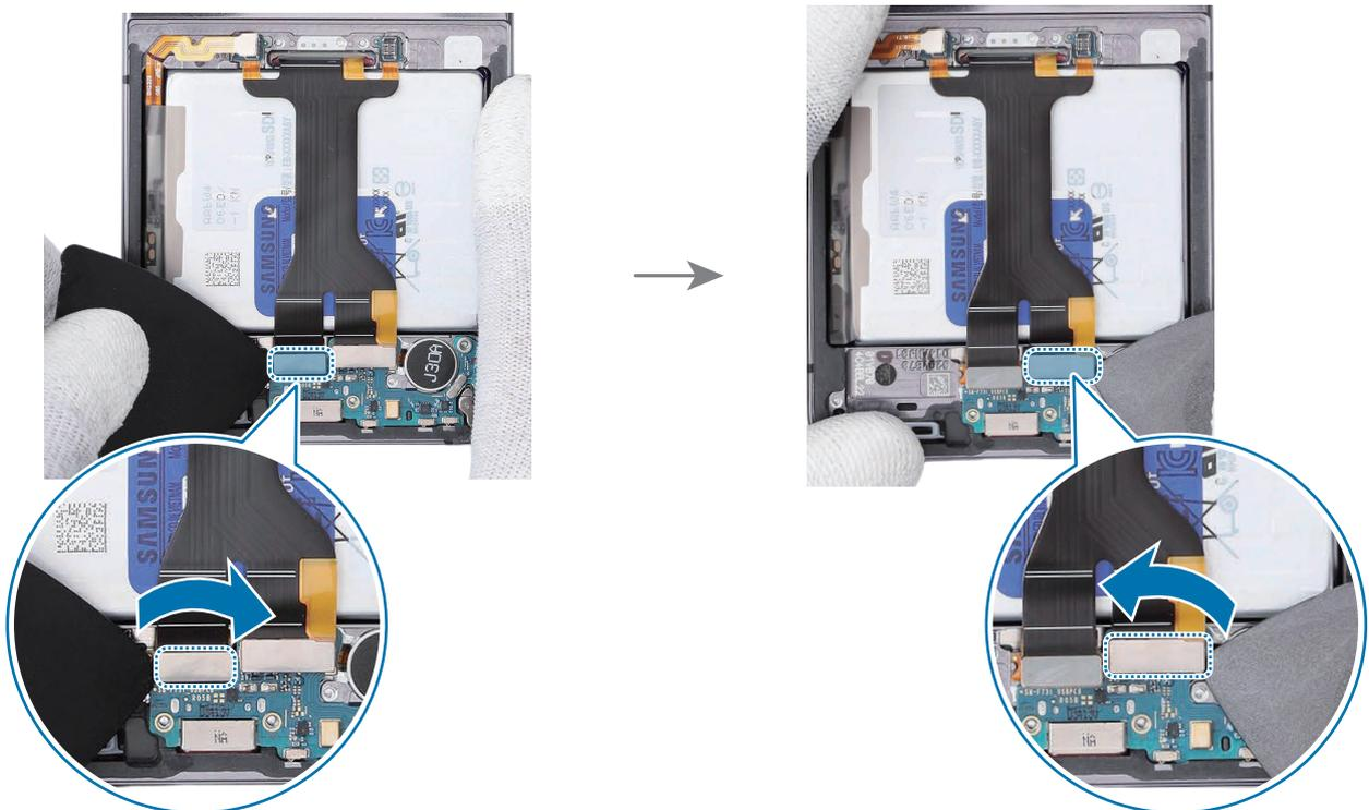
3 Levante los cables de la FPCB con cuidado, y después levante la muesca de separación hacia la parte superior izquierda del módulo del puerto de carga con la ayuda de las pinzas o la barra de desmontaje. A continuación, extráigalo.
