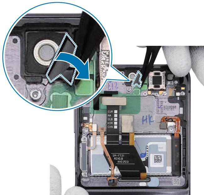
3 Con las pinzas o los dedos, retire la película de protección metálica superior colocada sobre el nuevo módulo de pantalla.
