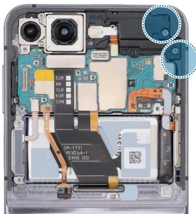
9 Conecte el conector de la batería principal a la placa principal.
