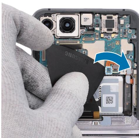
10 Con las pinzas, levante la muesca de separación situada en la parte inferior derecha de la placa principal y retire el módulo de esta.
