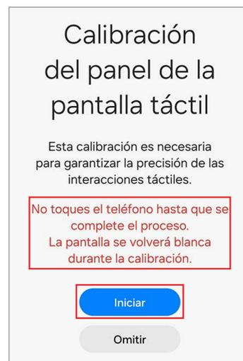
5 La calibración se realizará automáticamente y la pantalla se pondrá en blanco durante la calibración.
