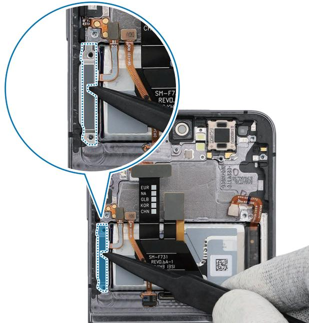
8 Compruebe el tornillo 3442 (2 unidades) en los dos puntos distintos del soporte de metal y fíjelos con un destornillador de estrella.
