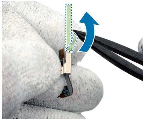
5 Inserte el módulo de la antena 5G mmWave en la ranura derecha con las pinzas o los dedos. Presione ligeramente con los dedos para que el módulo quede totalmente encajado.
