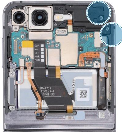
5 Use la púa de apertura para desconectar el conector del flash de la placa principal.
