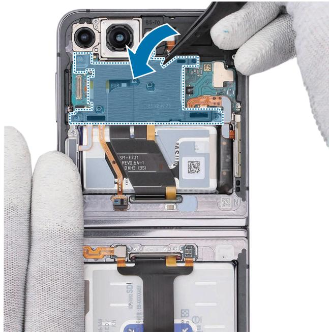
3 Use la púa de apertura para desconectar el conector de la batería principal.
