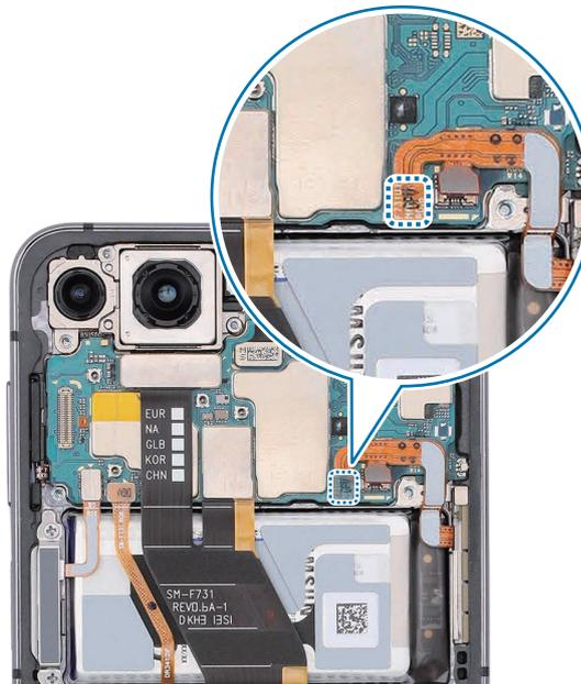
5 Compruebe el tornillo 3487 (1 unidad) y fíjelo en el chasis de la cámara con un destornillador de estrella.
