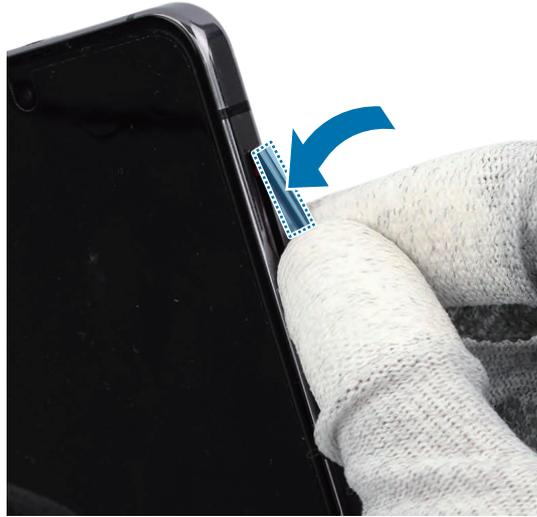
3 Presione el botón Volumen con cuidado y de manera uniforme para que pueda ensamblarse completamente.
