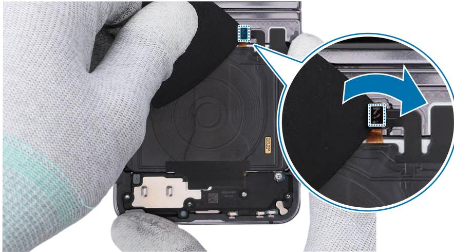
6 Use las pinzas o la púa de apertura para separar las cintas adhesiva del módulo de carga inalámbrica.
