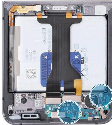
2 Desconecte los dos conectores del cable de la FPCB del puerto de carga con la púa de apertura.
