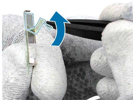
**3** Coloque el conector en el hueco del nuevo soporte de metal con el conector colocado debajo del soporte de tornillo más largo.
