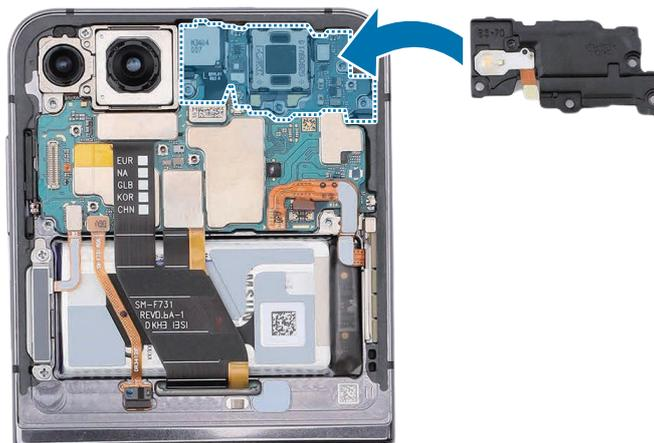
7 Use las pinzas y los dedos para conectar el conector del flash en la placa principal.
