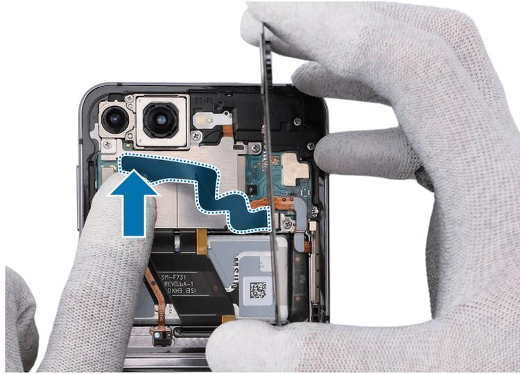
5 Monte la tapa del conector del cable de la FPCB de la pantalla frontal con las pinzas o los dedos y presione la tapa con suavidad.
