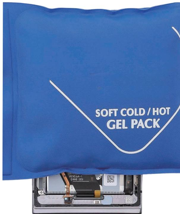
2 Antes de que se enfríe el calor aplicado con la bolsa térmica, retire la espuma adhesiva entre la cámara frontal y el módulo de pantalla con la ayuda de la anilla de extracción de la bandeja de la SIM.
