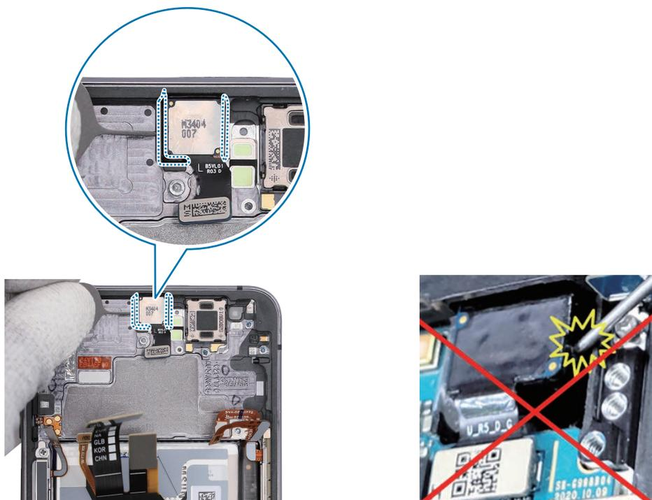
3 Con cuidado, retire la cámara frontal con las pinzas o los dedos y deje la lente de la cámara hacia arriba.
