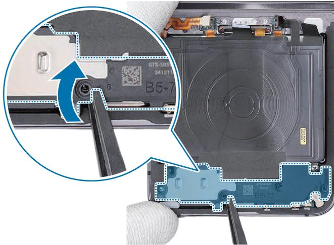
8 Separe el módulo de carga inalámbrica y el módulo del altavoz del dispositivo a la vez.
