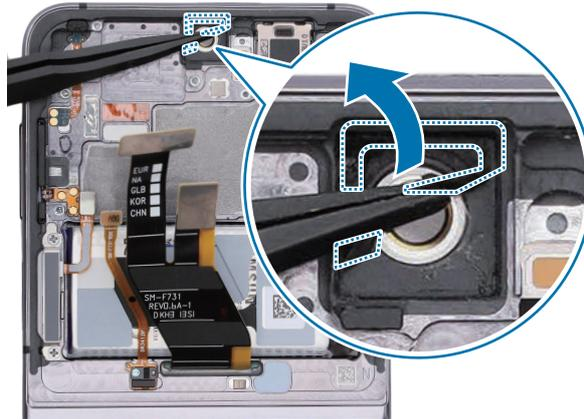
2 Retire con las pinzas la película protectora de una nueva cinta adhesiva para la cámara frontal.
