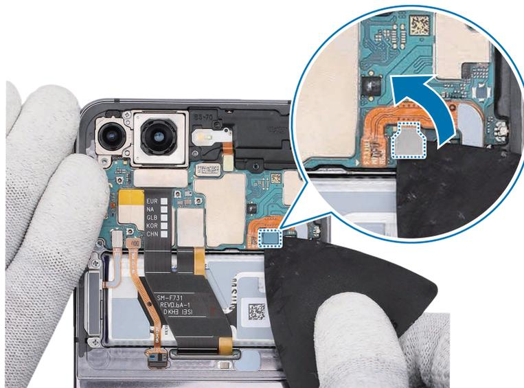
4 Compruebe los tornillos en los dos puntos distintos de la tapa posterior superior y retírelos con un destornillador de estrella.
