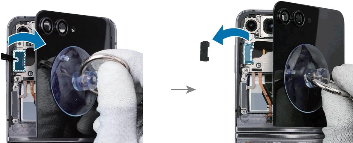
15 Desmonte el conector del cable de la FPCB de la pantalla frontal y separe la pantalla frontal por completo.
