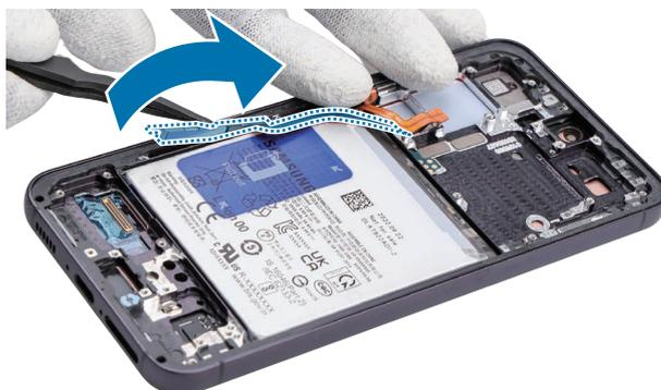
5 Retire el módulo de la antena 5G mmWave inferior.
