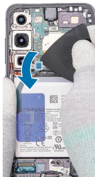
8 Con las pinzas, levante la muesca de separación situada en la parte superior derecha de la placa principal con cuidado y retire el módulo de la placa principal.
