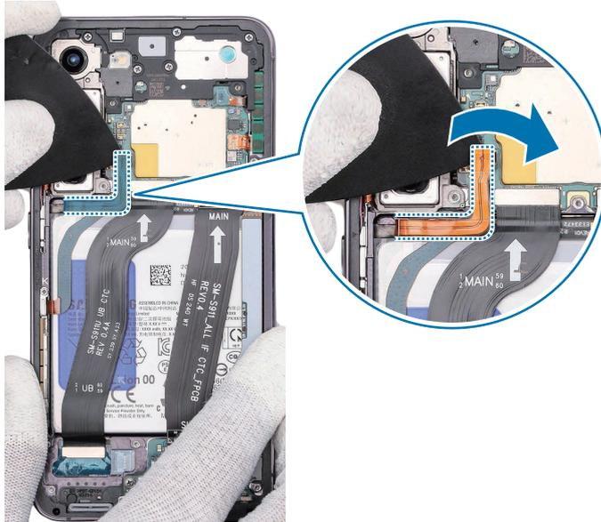
2 Agarre y tire con suavidad del primer cable de interconexión del chasis con la púa de apertura o la barra de desmontaje.
