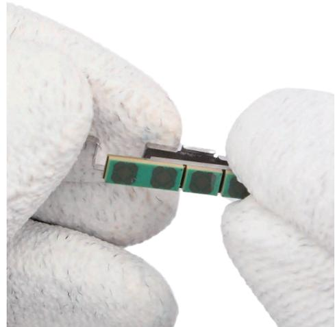
3 Monte la antena 5G mmWave con el conector.
