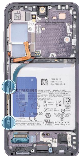
4 Inserte el extremo en punta de las pinzas en el hueco que hay entre el soporte del tornillo inferior del soporte de la antena 5G mmWave izquierda y el chasis.
