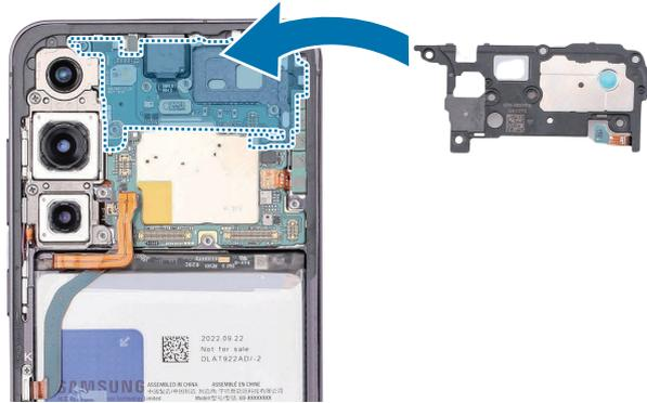
6 Use las pinzas o los dedos para conectar el conector del cable del FRC superior en la placa principal.
