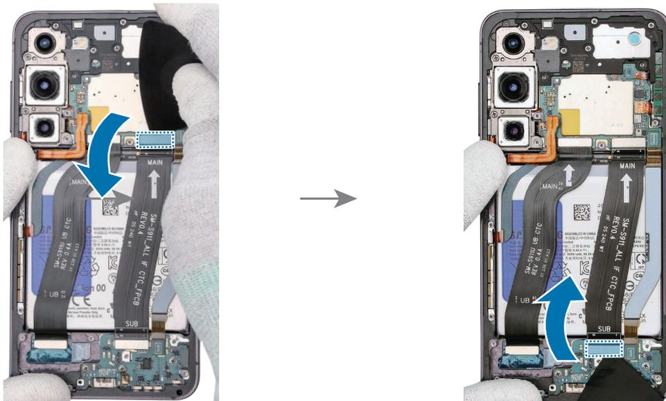
3 Agarre y tire con suavidad del segundo cable de interconexión del chasis con la púa de apertura o la barra de desmontaje.
