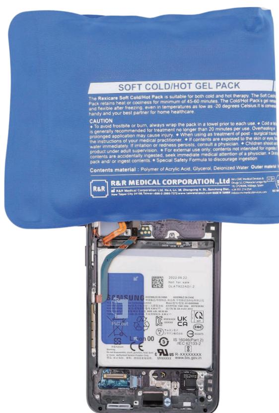
2 Antes de que se enfríe el calor aplicado con la bolsa térmica, retire la espuma adhesiva entre la cámara frontal y el módulo de pantalla con la ayuda de la anilla de extracción de la bandeja de la SIM.
