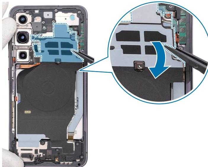
5 Separe el módulo de carga inalámbrica y el módulo del altavoz del dispositivo a la vez.
