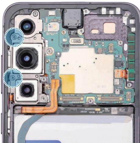
6 Use la púa de apertura para desconectar el conector de la cámara frontal de la placa principal.
