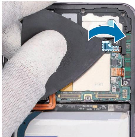
4 Use las pinzas para levantar la parte inferior del altavoz superior con cuidado y sepárelo de la placa principal.
