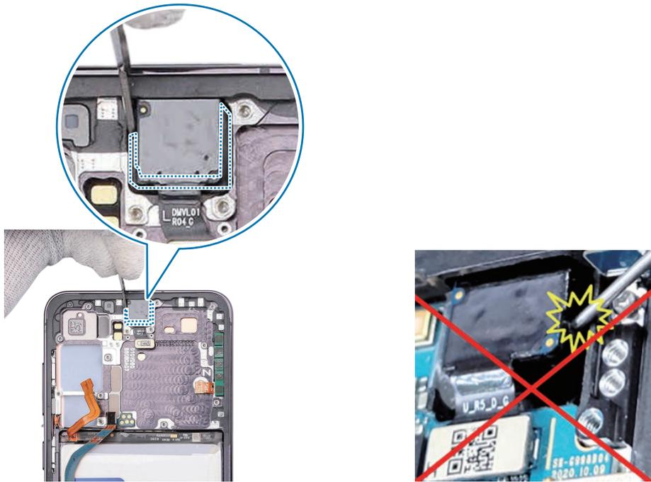
3 Con cuidado, retire la cámara frontal con las pinzas o los dedos y deje la lente de la cámara hacia arriba.
