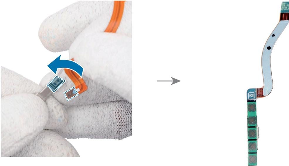
4 Retire el fino revestimiento adhesivo de la parte exterior del soporte de metal e introduzca el módulo de la antena 5G mmWave en la ranura inferior izquierda con las pinzas o los dedos. Presione ligeramente con los dedos para que el módulo de la antena quede totalmente encajado.
