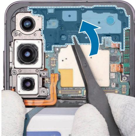
5 Compruebe los tornillos en los dos puntos distintos del chasis de la cámara y retírelos con un destornillador de estrella.
