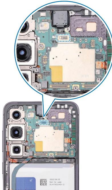
3 En el caso de los dispositivos 5G de los Estados Unidos, use las pinzas o los dedos para conectar los dos conectores adicionales de la antena 5G mmWave de la placa principal.
