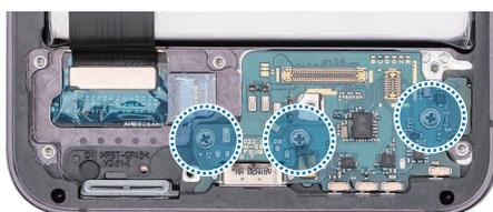
3 Conecte los dos cables de interconexión a la placa principal y al puerto de carga.
