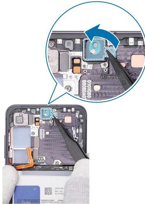
5 Coloque la cámara frontal en el orificio de la cámara de forma que la lente esté orientada hacia delante e inserte con suavidad la cámara frontal.
