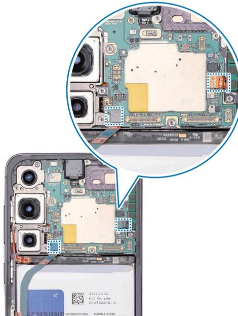
4 Compruebe los tornillos 3428 (2 unidades) en los dos puntos distintos del chasis de la cámara y fíjelos con un destornillador de estrella.
