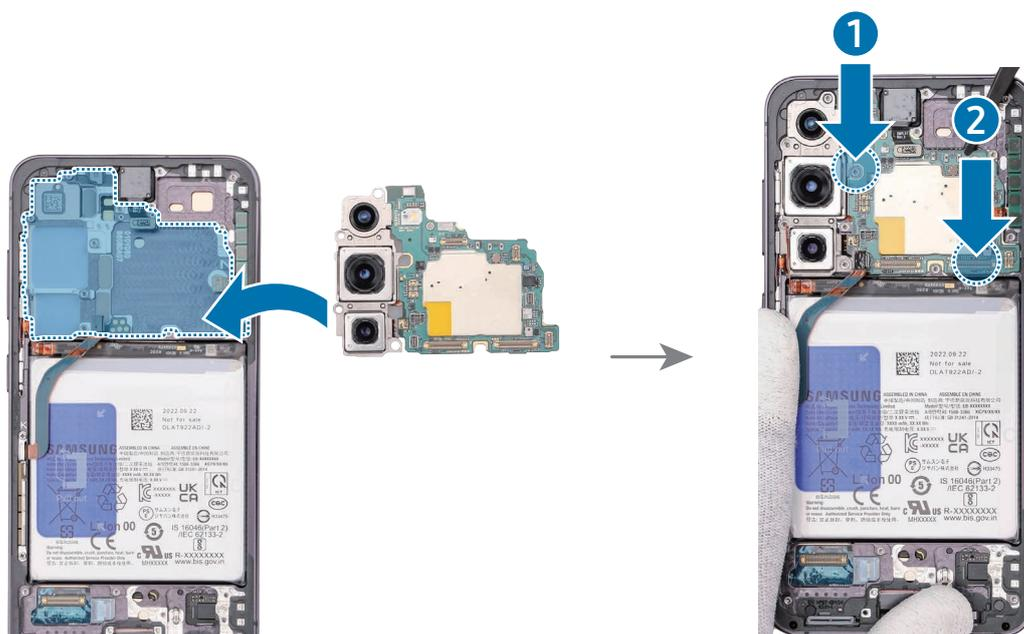
2 Use las pinzas o los dedos para conectar el conector de la cámara frontal en la placa principal.
