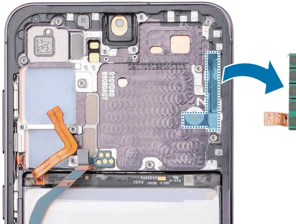
3 Compruebe los tornillos en los dos puntos distintos en el módulo de la antena 5G mmWave izquierda y retírelos con un destornillador de estrella.
