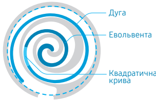
Спіраль з потрійним профілем Advanced Flash Injection (90 см 3 ) 2021
