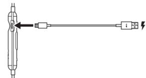
充電中は、リモコンの電源インジケータが赤く点灯し、充電が完了するとインジケータが消灯します。充電が完了したら充電用ケーブルを外してください。
