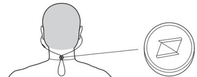
\* 左右のイヤホンの外側内部にマグネットが組み込まれています。耳から外しているときは、左右のイヤホンをマグネットで留めて不要な動きを防ぐことができます。
