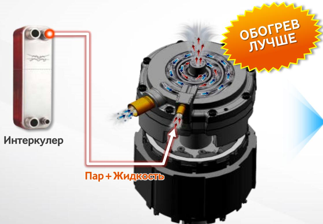
※ **Flash инжекция** : инжекция паро-жидкостной смеси для повышения расхода хладагента при низкой наружной температуре.
